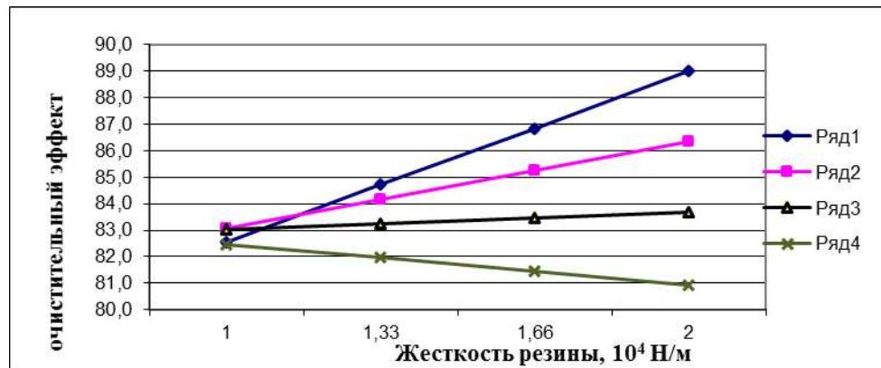
а - графики изменения очистительного эффекта от вариации жесткости резиновой втулки колосников, где 1-при  $x_2=5,0$  т/ч,  $x_3=12$  мм, 2- при  $x_2=5,33$  т/ч,  $x_3=13,32$  мм, 3- при  $x_2=5,66$  т/ч,  $x_3=14,64$  мм, 4-при  $x_2=7,0$  т/ч,  $x_3=16,0$  мм.
