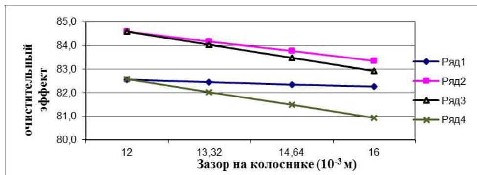
в - графики изменения очистительного эффекта от вариации зазора между колосником и пильным цилиндром. Где 1-при  $x_1=1,0 \cdot 10^4$  Н/м;  $x_2=5,0$  т/ч, 2-при  $x_1=1,33 \cdot 10^4$  Н/м;  $x_2=5,56$  т/ч, 3-при  $x_1=1,66 \cdot 10^4$  Н/м;  $x_2=6,32$  т/ч, 4-при  $x_1=2,0 \cdot 10^4$  Н/м;  $x_2=7,0$  т/ч.
