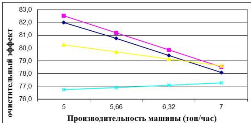
б - графики изменения очистительного эффекта от вариации производительности машины, где, 1- при  $x_1=1,0 \cdot 10^4$  Н/м;  $x_3=12$  мм, 2-при  $x_1=1,33 \cdot 10^4$  Н/м;  $x_3=13,32$  мм, 3-при  $x_1=1,66 \cdot 10^4$  Н/м;  $x_3=14,64$  мм, 4-при  $x_1=2,0 \cdot 10^4$  Н/м;  $x_3=16,0$  мм.
