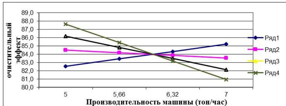
б - графики изменения очистительного эффекта от вариации производительности машины, где, 1- при  $x_1=1,0 \cdot 10^4$  Н/м;  $x_3=12$  мм, 2-при  $x_1=1,33 \cdot 10^4$  Н/м;  $x_3=13,32$  мм, 3-при  $x_1=1,66 \cdot 10^4$  Н/м;  $x_3=14,64$  мм, 4-при  $x_1=2,0 \cdot 10^4$  Н/м;  $x_3=16,0$  мм.
