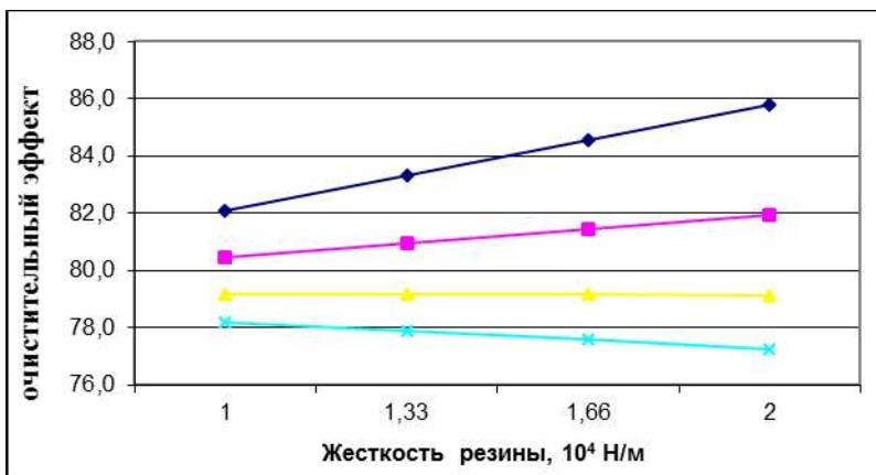
а - графики изменения очистительного эффекта от вариации жесткости резиновой втулки колосников, где, 1-при  $x_2=5,0$  т/ч,  $x_3=12$  мм, 2- при  $x_2=5,33$  т/ч,  $x_3=13,32$  мм, 3- при  $x_2=5,66$  т/ч,  $x_3=14,64$  мм, 4-при  $x_2=7,0$  т/ч,  $x_3=16,0$  мм.
