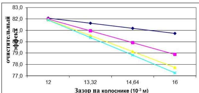
в - графики изменения очистительного эффекта от вариации зазора между колосником и пильным цилиндром. Где 1-при  $x_1=1,0 \cdot 10^4$  Н/м;  $x_2=5,0$  т/ч, 2-при  $x_1=1,33 \cdot 10^4$  Н/м;  $x_2=5,56$  т/ч, 3-при  $x_1=1,66 \cdot 10^4$  Н/м;  $x_2=6,32$  т/ч, 4-при  $x_1=2,0 \cdot 10^4$  Н/м;  $x_2=7,0$  т/ч.
