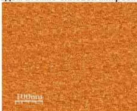
Рисунок 4. Двумерные изображения поверхности тонких пленок Mn_4Si_7 , полученные методом атомно-силовой микроскопии
