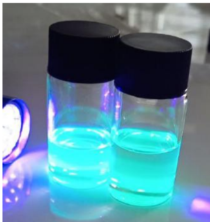
6-rasm. Sintez qilingan CsPbBr 3 tarkibli perovskit kvant nuqtalari eritmasining ultrabinafsha nurlar ostida ko'rinishi.
