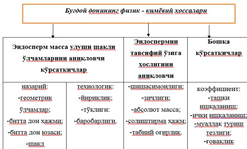
Расм-1. Буғдой донининг физик-кимёвий хоссаларини ташкил этувчи кўрсаткичларнинг блок схемаси
